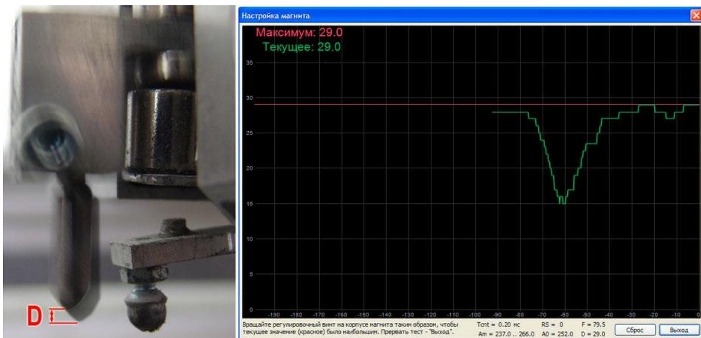
Рис. 18.2. Окно настройки электромеханического виброгенератора в программе *Engrave*.
