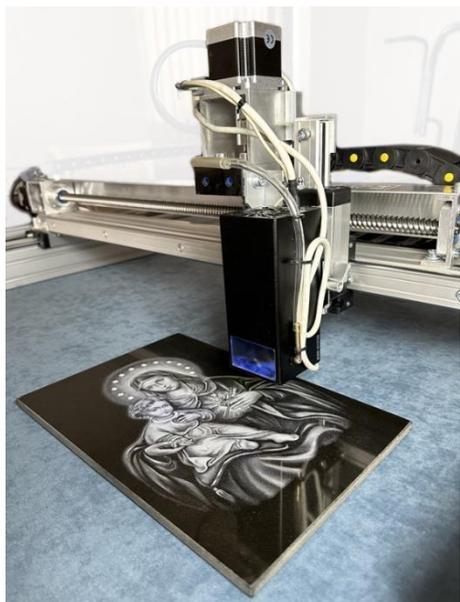
Диодная лазерная головка может устанавливаться на ударные, лазерные и фрезерные станки «САУНО» в качестве сменной головки для лазерной гравировки и резки. Диодная лазерная головка устанавливается:
