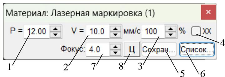
Рис.8.4. Панель «Материал» в лазерном режиме (векторная гравировка).
