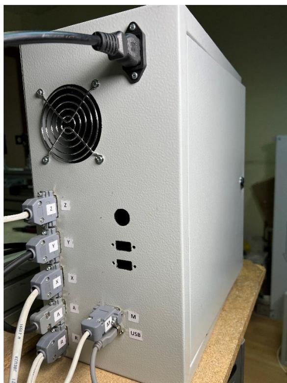
Рис. 3.7. Микропроцессорный блок управления.
