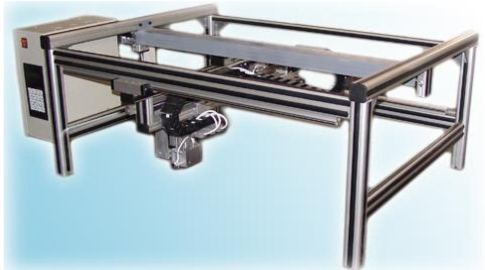
Рис. 3.1. Гравировальный станок-автомат «График-ЗК».
