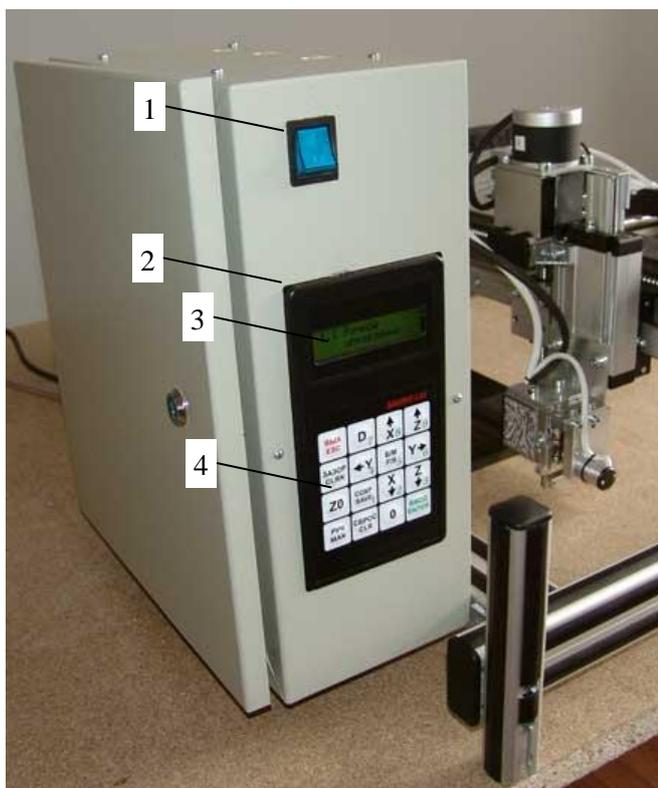
Рис. 3.6. Микропроцессорный блок управления.
