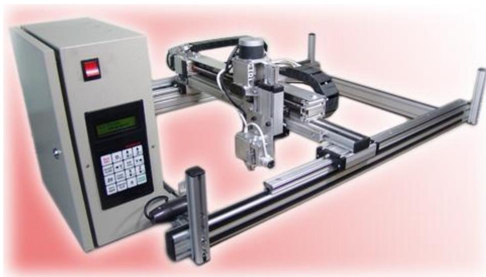
Рис. 3.2. Гравировальный станок-автомат «График-ЗКП» (базовое исполнение).
