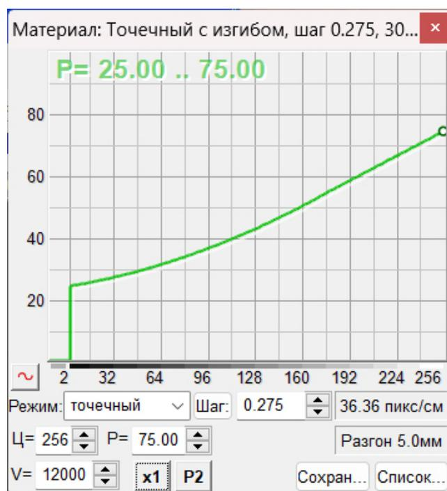
Рис. 8.2б. Панель «Материал» в лазерном режиме (растровая гравировка, **диодный лазер**).
